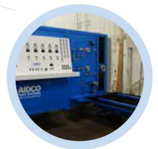
变速器测功机 PowerNet TD 适合在变速器、变矩器、液压泵和电机上使用 AIDCO 试验系统的用户。
